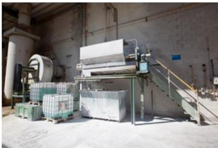
Filtro prensa de tortas de lodos de fosfatado.
